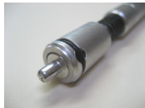
② リベットをツールにセットします。 リベットは、ベアリングにより固着されます。
