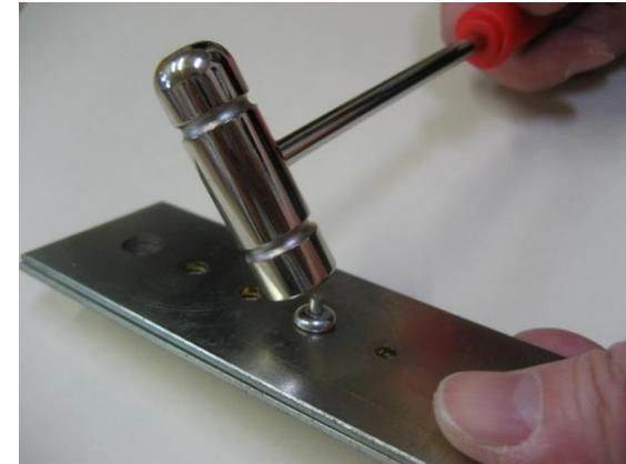
② ドライブリベットを締結部材の下穴に挿入します
